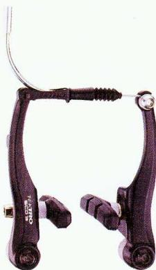
▲TEKTRO SCD3：以「便捷性」為出發點的SCD3登山車煞車夾器，具有「自動回位功能」，使騎乘者在高度要求煞車力道的越野賽中免去回調，而整體採鋁合金製造，在重量與安全性也具一定水準。
