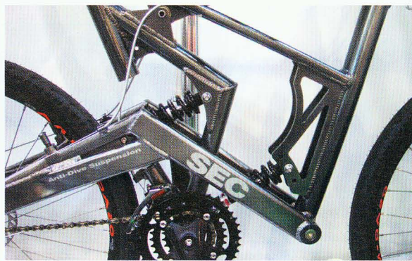
▲賽客後避震獨立懸吊 (ISI) 系統，是由2組避震器互相補助而成。
