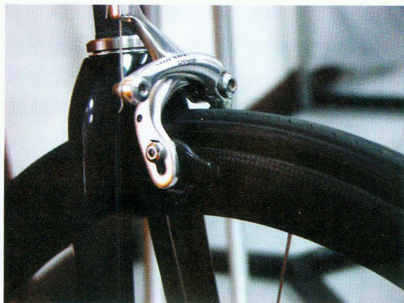
▲可明顯看出輪圈側壁上的「煞車道」。
