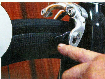
▲DBS整體煞車位置比一般的低。
