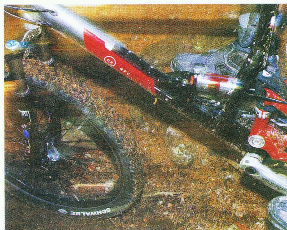
▲此款DT-Swiss HVR-200避震器，絕對有潛力與Manitou SPV及Progressive Suspension的第五元素一較長短，但必須經過一些較精密調校。
