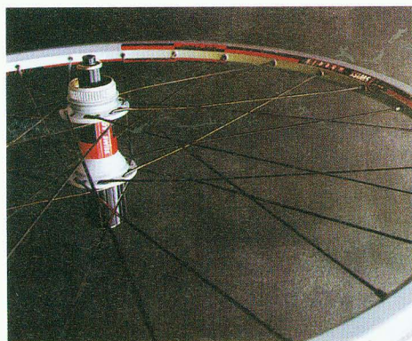
▲亮相：DT-Swiss輪組「XR1540」，搭配240S花鼓(中央鎖系統)及XR 4.1輪圈，整組輪組只有1,545公克重。
