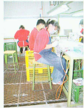
▲鎂合金的粉塵易燃，工作台下設置水槽以集塵並防燃。
