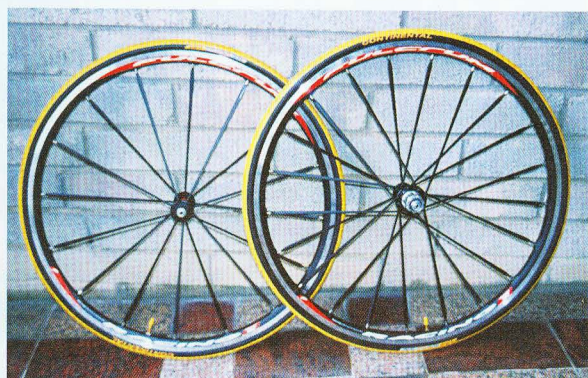
▲輕量夢幻輪組：Fulcrum 頂級輪組 Racing 1，採無孔平面輪圈外側設計，免內襯帶，僅重 1,579 公克。
