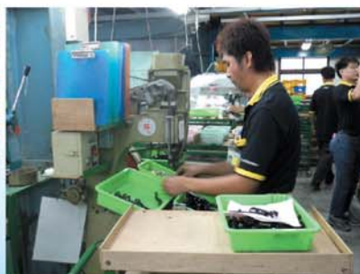
▲井然有序的彥豪生產現場，目前已由輸送帶改為工作站的作業方式，員工須站立生產，目前所有流程改造與設備的設計皆由工廠內自行設計施工製造。
