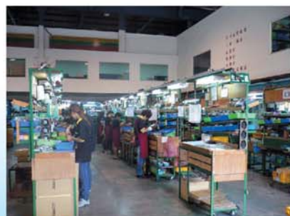
▲井然有序的彥豪生產現場，目前已由輸送帶改為工作站的作業方式，員工須站立生產，目前所有流程改造與設備的設計皆由工廠內自行設計施工製造。
