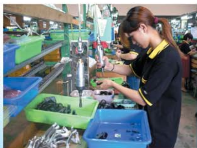
▲井然有序的彥豪生產現場，目前已由輸送帶改為工作站的作業方式，員工須站立生產，目前所有流程改造與設備的設計皆由工廠內自行設計施工製造。
