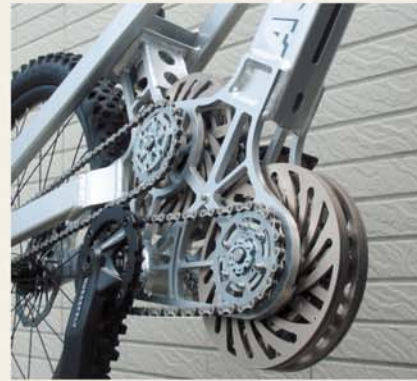
▲藉由前、後兩片Auto G'X組成的傳動系統，經測試後可提升變速比達625%以上。
