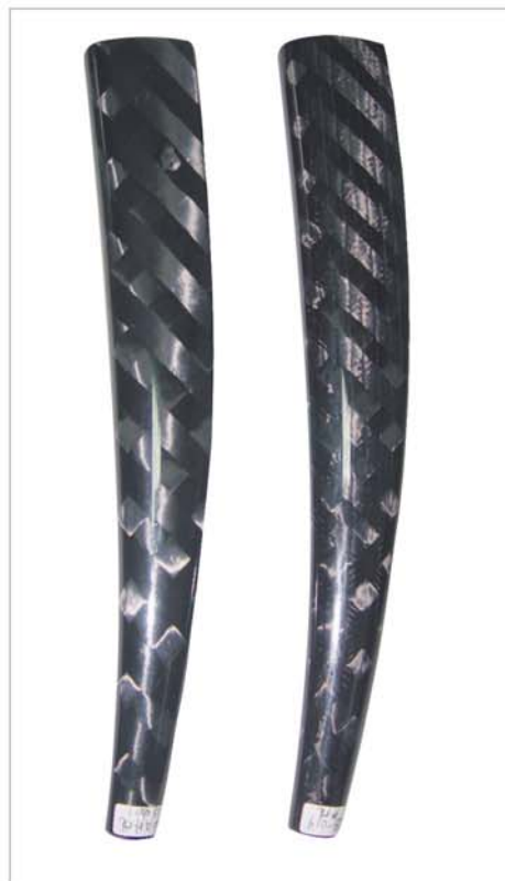
▼▲採用多軸編織設計的碳纖維成品(右)，從外觀上即能明顯看出其差異性。
