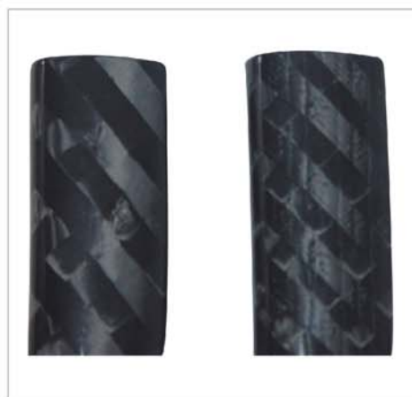
▼▲採用多軸編織設計的碳纖維成品(右)，從外觀上即能明顯看出其差異性。
