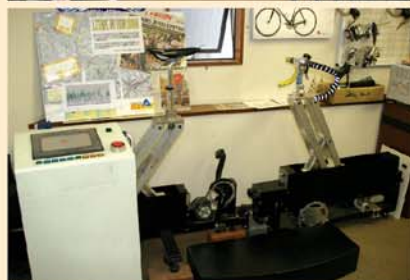
▲價值3百萬日幣的車架尺寸測量設備。
