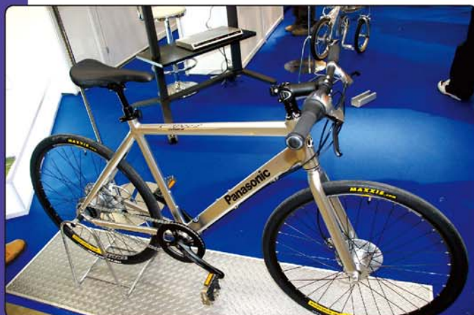
▲Panasonic搭配Shimano內8速系統的登山車，後上叉有作逆Y字的剛性強化設計。
