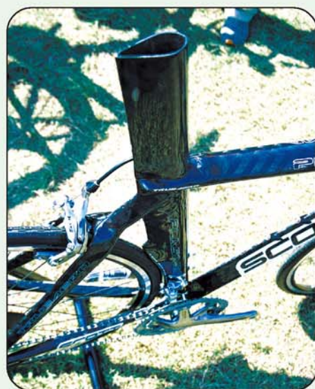
▲▶ Scott 最新力作碳纖維三鐵車 PLASMA，運用 True-Aero 技術，車架管件前後截面如同機翼般流線造型。
