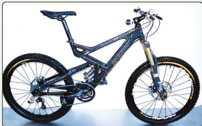
▲▲ RANSOM 運用 CR1 碳纖維技術並結合多項高科技設計，所搭配的 Equalizer TC 後避震器可同時提供 165、90、0mm 避震行程，整車重量約 13.5-14kg。
