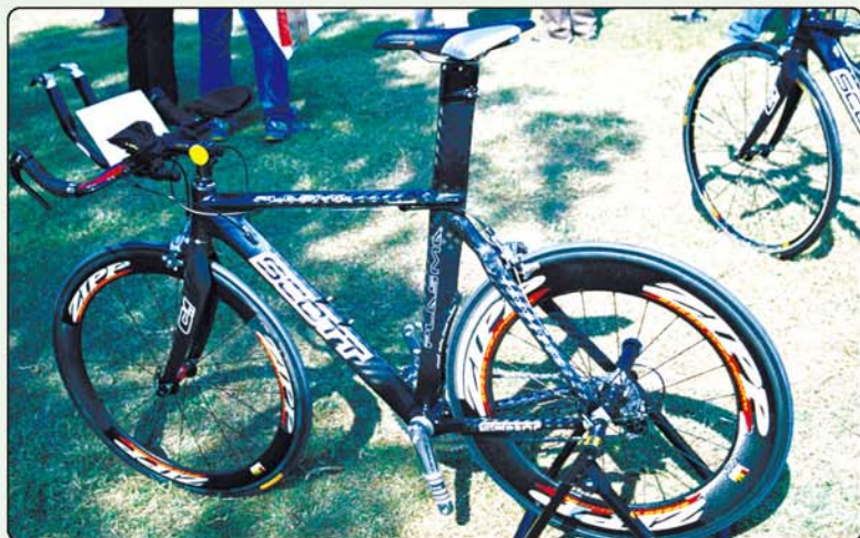
▲▶ Scott 最新力作碳纖維三鐵車 PLASMA，運用 True-Aero 技術，車架管件前後截面如同機翼般流線造型。
