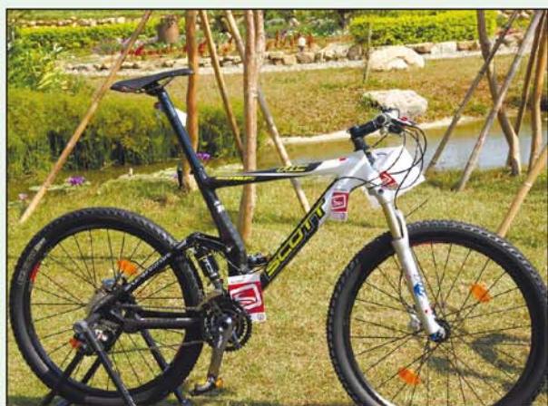
▲▲ 針對越野競賽設計的 GENIUS，除了在上、下管變動外，專屬的 TC 後避震器也進行小改款。
