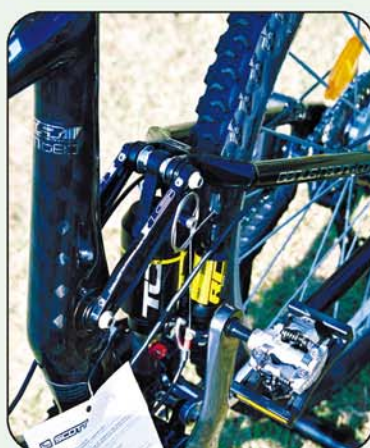
▲▲ 針對越野競賽設計的 GENIUS，除了在上、下管變動外，專屬的 TC 後避震器也進行小改款。
