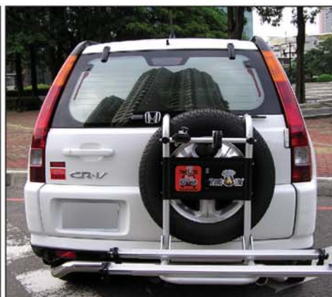
▲SBC 攜車架則以 6061 鋁合金製成，並以 T 碳 5 級硬化處理，來加強承載性。
