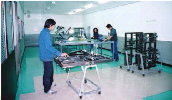
▲膠合材料必須在環境控管嚴格的無塵室中進行。
