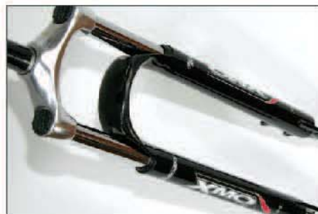
▲ MOZO 新一體成型專利管材：外型流線美觀、產品無需焊接、扭力比傳統強 10 倍。
