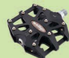
▲Wellgo B-83：BMX用大踏面設計，採鋁擠型以及CNC加工，有潤滑油添加孔，易於保養，且有止滑釘設計。
