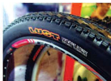
▲LUST技術的無內胎車胎，強調胎邊防刺與避免車胎漏氣的效果。
