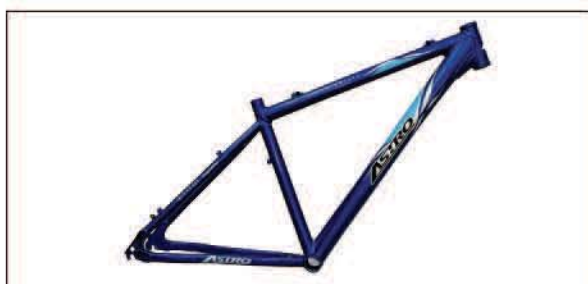
▲ASTRO Xtrolite的登山車車架，重量可控制在1.2kg左右。
