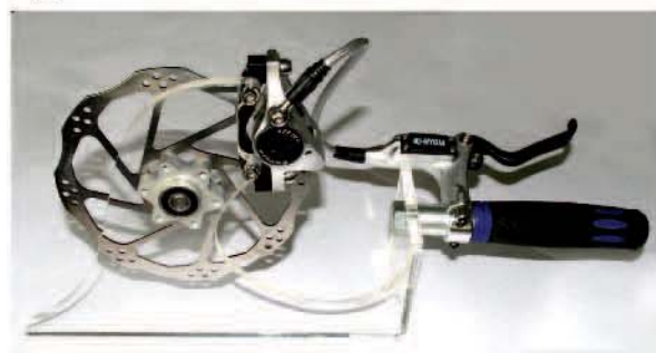
▲ASPIRE前、後系統總重量（含碟煞片）僅903g。
