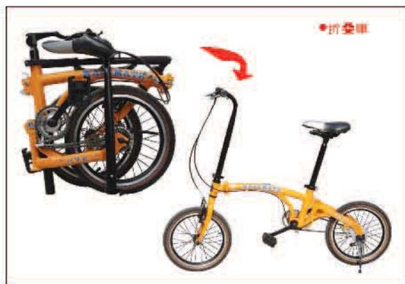
對他人的妨礙小；可以存放在汽車裡，滿足人們四加二輪的休閒生活。這款折疊車除了強調騎行的舒適度外，更在細節上做足功夫，並擁有四項專利：1. 折疊的座墊無需加扣自動鎖緊；2. 車把側向磁鐵固定；3. 前輪固定鎖緊；4. 鏈條自動折疊。使折疊後車身體積更小，且可以拎著亦可推行。
