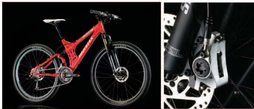
▲MATRIX-ONE搭配了Spinner Aeris-sport智慧型輕量化前叉SPUL系統、HYGIA ASPIRE全油壓碟煞系統與Shimano Deore傳動系統。
