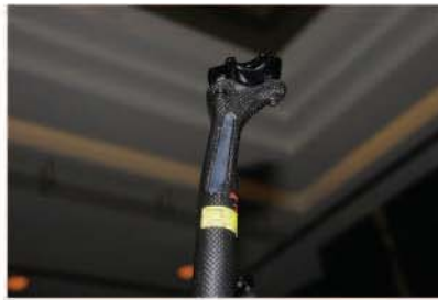
▲ 2007年Specialized 最新公路車款，在前叉、後上管與座管上鏤空，填入避震矽膠Zertz，讓車架在舒適與輕量上取得平衡。
