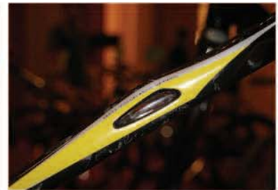
▲ 2007年Specialized 最新公路車款，在前叉、後上管與座管上鏤空，填入避震矽膠Zertz，讓車架在舒適與輕量上取得平衡。
