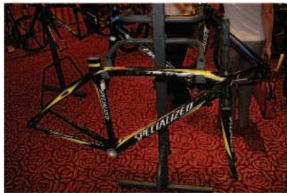
▲ 2007年Specialized 最新公路車款，在前叉、後上管與座管上鏤空，填入避震矽膠Zertz，讓車架在舒適與輕量上取得平衡。
