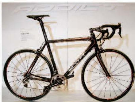
▲SCOTT ADDICT採用最新的IMP技術，車架重量僅790克。
