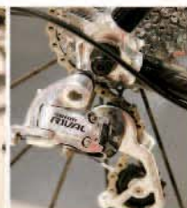
▲SRAM的Rival以鋁合金為主要材質，C/P值頗高，整套變速系統僅2,227克。
