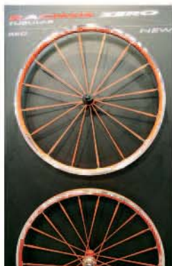
▲Fulcrum競賽用的Zero輪組，在不影響強度的狀況下減少了內壁厚度，僅重1,465克。
