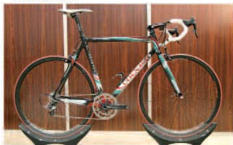
▲Colnago的Extreme Power在車架前三角增加了碳纖維的用量，使強度得以提升30%。
