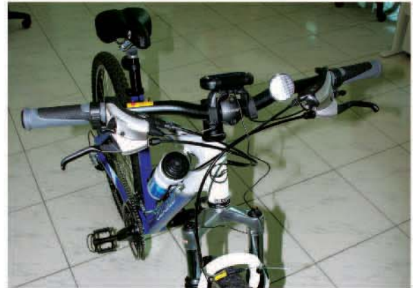
▲ET-600車錶將所有資料傳輸線規劃在車錶下端，讓走線不會過於零亂。
