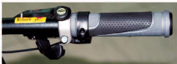
▲橡膠式的2片2點式感應裝置，就設置在自行車的握把套上。
