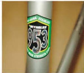
▲ 張力強度可以達到 2,000 MPa 的 Reynolds 953 管材，不僅可承受強大的衝擊力，耐腐蝕又不易出現金屬疲勞。
