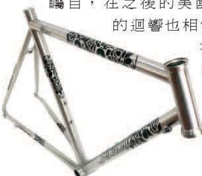
▲ Reynolds 953 管材在台灣雲豹與鈦郁工業齊心協力之下，打造出「雷諾 953」超級不鏽鋼車架。
