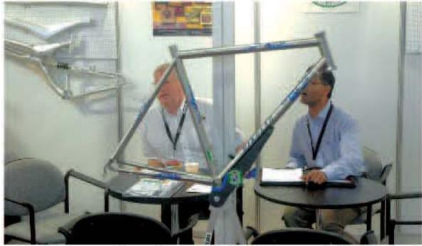
▲ 雷諾 953 兼具了輕、快、舒適的特性，再加上抗腐蝕性以及高撞擊性；圖為 2006 年 Eurobike Reynolds 攤位中展出的雷諾 953 車架。
