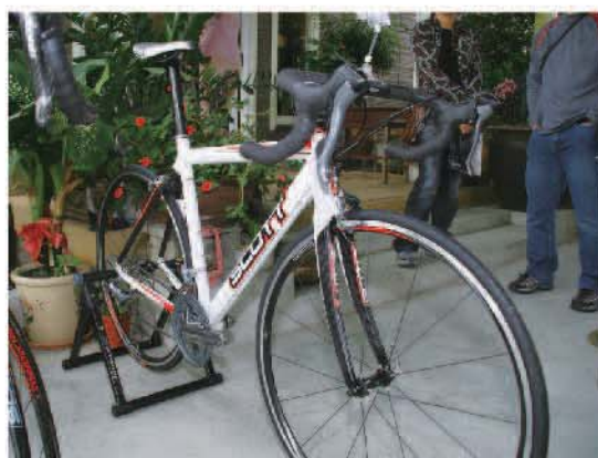
▲ CR1 碳纖+鋁合金車架的入門公路車款 SPEEDSTER S20，搭配 Shimano 105 變速套件。
