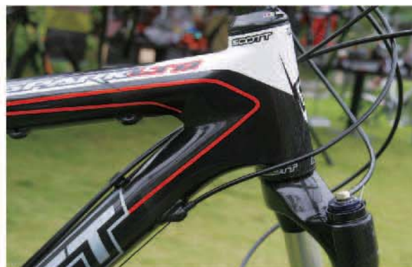
▲SPARK LTD頭管採CAD、FEA軟體精密計算分析後，在透過HMX超高剛性碳紗以IMP模內成型技術製成，不但又硬又輕，外觀也完美無瑕。
