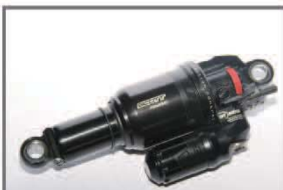
▲ SCOTT 與 DT Swiss 合作開發的 Nude TC 後避震器，擁有全開 (110mm)、半開 (70mm) 與鎖死 (0mm) 功能，僅重 240g。
