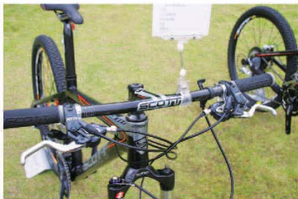
▲ Scott以HMF高張力碳纖維為材質，採一體成型方式製成的PILOT車手把，重230g。
