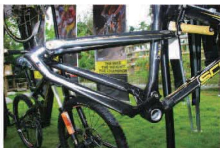
▲ SPARK車架後下叉採不對稱設計，可明顯看出碟煞端比後變速器那端還要高。
