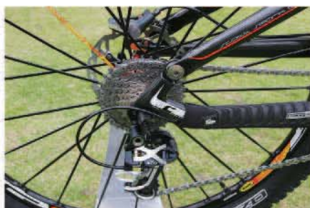
▲ SPARK採用了專利SCDS碳纖維鉤爪，搭配7075鋁合金替換式吊耳，LTD版的變速系統則搭配了全新XTR變速系統。
