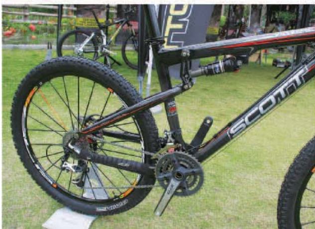
▲車架中除了後叉上管採用CR1技術之外，其他部位均採IMP碳纖維技術製成；由於Nude TC後避震器尚未到貨，展示時以Fox後避震器暫時替代。
