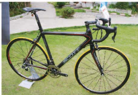
▲專為競賽設計的ADDICT LTD公路車，同樣採用IMP技術製成，僅重5.9Kg（M尺寸，含腳踏）。
