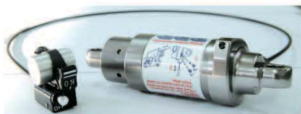
▲機械式後避震器沒有漏油、漏氣的問題，維修率低。
