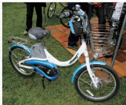
▲ Giant電動車的詢問度頗高，其中專為年青人設計的LaFree 231電動助力車，採用鉛酸電池，可透過煞車熱能回充電源，續航力可達30km。
