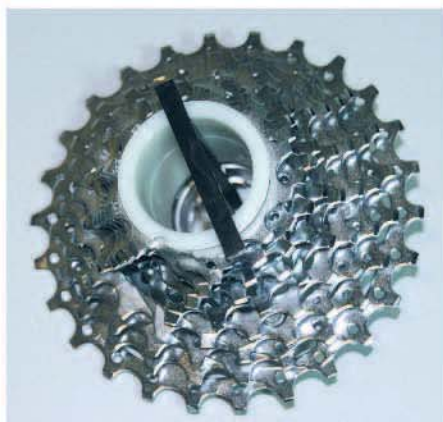
▲飛輪採用減齒設計後，不但變輕，且跳速更順暢：圖為擁有4種齒片搭配的公路車專用的OG-1070飛輪。
