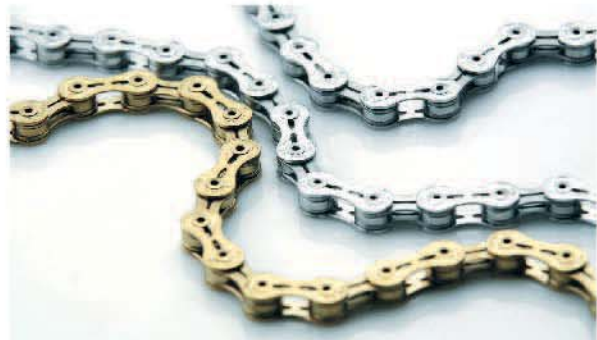
▲KMC X-SL系列鏈條是目前所有品牌同等級中最輕量的鏈條。內片挖空的結構，有助於移除卡在鏈條內部的髒污。中空軸銷釘方式，採用最新的處理工法，小軸嵌合力可達350kgf，成為時下最堅固耐用的鏈條。
