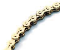
▲專門為競速車設計的魔鏈 D101，外鏈片的凹槽與布希凸出內鏈片的結構配合，減少相互間隙，有效防止泥沙進入布希內部，提升鏈條的耐磨性。
