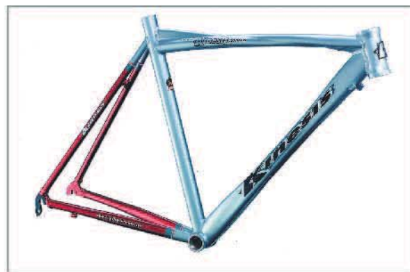
▲ 卜威在車架上大量採用 SPF 技術後，重量比油壓成形輕量許多。
