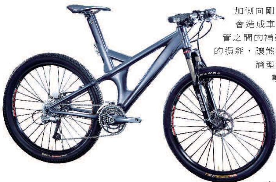
加側向剛性，因此抽車加速也不會造成車身的扭曲；後三角上下管之間的補強則可以減少碟煞作動的損耗，讓煞車更直接、有效。而水滴型座管剛性佳，也可避免較長的座管在遇到顛簸路面時，發生折斷的危險。整體而言，強調剛性的Nicky加速性強，適合喜歡騎柏油路面登山爬坡的車友使用。
