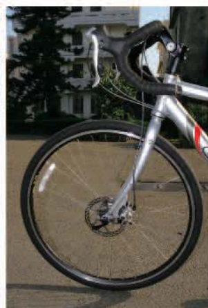
▲億鎮針對公路車與Touring等700C輪組車款，推出專用的機械式碟煞系統。
