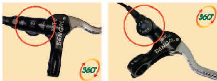
▲億鎮在 Helix-1.0 的煞車把手上採用可 360 度旋轉的獨家專利，讓使用者不需透過其他工具，就能調整蓄油槽最佳位置。
