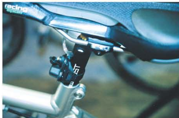
▲強調人體工學設計的 Allay 座墊，車友可根據本身習慣透過座桿上的小按鈕自行充氣調整氣囊的軟硬度。
