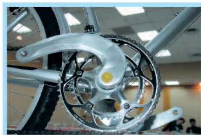
▲「彎形動力曲柄」採黃金螺旋造型，旋轉時會發揮前展效應，讓動力提前輸出並無上死點，可有效提升 40% 的動能輸出。
