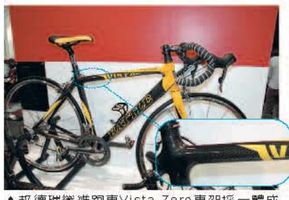
▲邦德碳纖維跑車Vista-Zero車架採一體成型Carbon製成，紋路就像魚鱗般搶眼。
