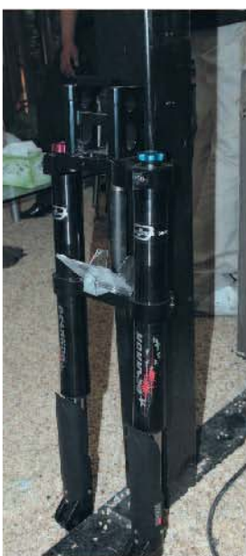
▲凱薩克針對越野機車需求，開發出180mm行程的DM-F5.0前叉。
