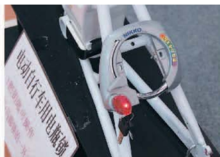
▲NIKKO整合電機系統的馬蹄型電動車鎖，具有警防盜警示功能。
