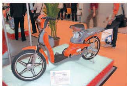
▲千錫電動車採用20吋240w高速有刷一體輪花鼓馬達。
