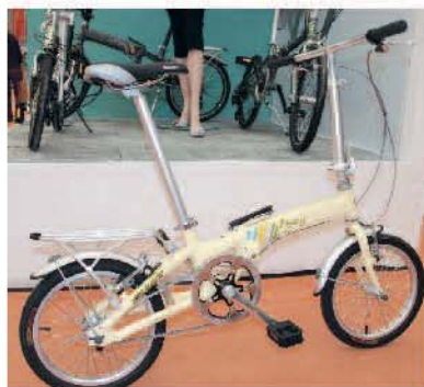
▲捷安特TRIWAY 6.0折疊車採全新開發的折疊機構，僅需1秒即可將車架收折。
