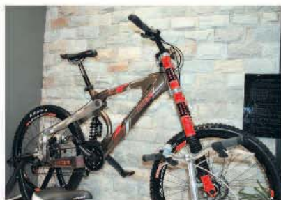
▲邦德推出的26吋超靈敏下坡車，四連桿結構看起來相當孔武有力。
