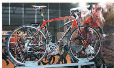
▲Specialized所展出2007年S-Works Tarmac SL Dura-Ace版公路車，在前叉與後叉採用專利矽膠避震技術。
