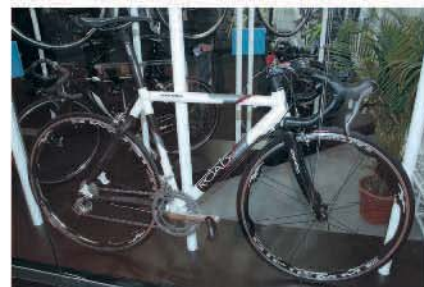
▲OYAMA公路車SC-01採用鈦合金與碳纖維製成的車架，搭配ADK前叉僅重8.9kg。
