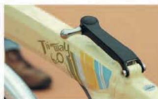
▲捷安特TRIWAY 6.0折疊車採全新開發的折疊機構，僅需1秒即可將車架收折。
