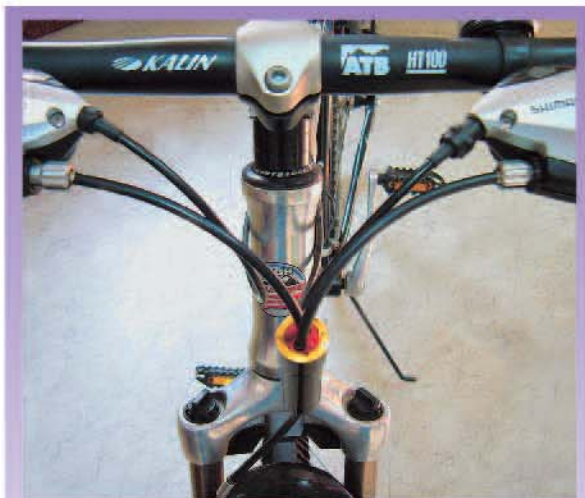
▲不論騎乘者先煞右煞車或左煞車，SQS系統能使後煞車功能永遠保持有效。
