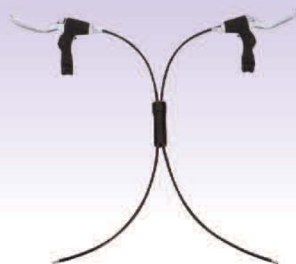
▲假設圖示左邊的煞車線與煞車把手是代表控制後煞車的煞車機構，右邊的煞車線與煞車把手則是代表控制前煞車的煞車機構。
