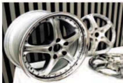
▲圖三鑄鍛合一之鎂合金／鋁合金複合材質輪圈。
