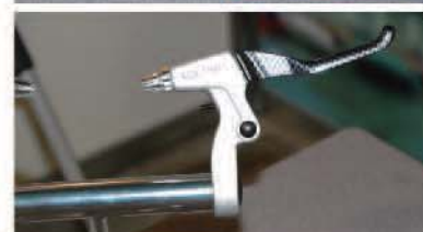
▲破鐵熱！鐘贏也推出破纖維包覆鋁合金的夾器與煞把，兼顧輕量與價格。
