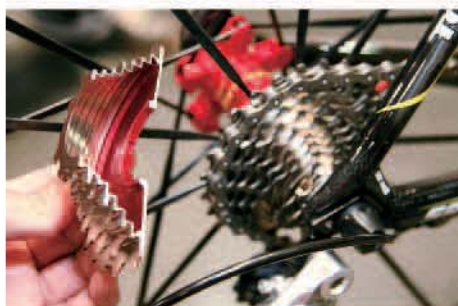
▲SRAM全新公路車變速套件備受矚目，十速飛輪採用八速一體式，再加兩片獨立飛輪的方式組合而成。
