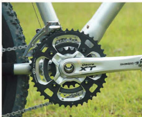
▲大齒盤的中齒片採用碳鋼複合式材質，兼顧輕量及強度。
