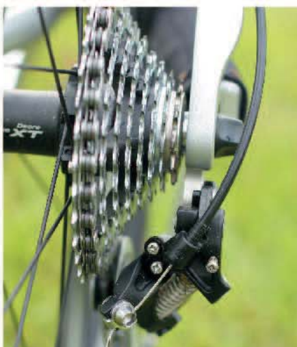
▲Shadow技術將後變速器往內縮，可以減少在林間小道騎乘時發生碰撞。
