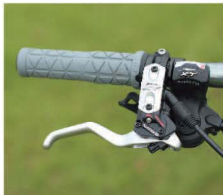
▲XT變速手把可隨使用者將其安置在煞車手把內外，改版後的外型質感也大大提升。
