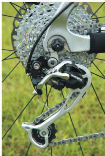
▲Shadow仿效XTR，採用「X」型外觀與金屬結構。
