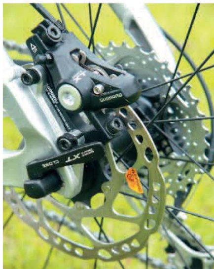
▲一體成型的XT卡鉗，可讓制動力增強20%。
