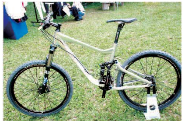
▲採 Maestro 避震系統設計的 TRANCE X0，加上車架拉絲處理，讓車架更輕量且質感更佳。
