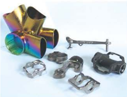
▲精密鑄造的零件，其剛性、複雜性及精確性，遠非其他鍛造法可比。
