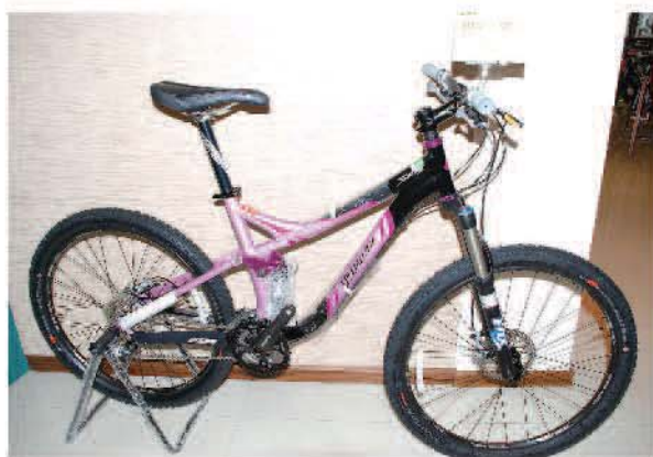
▲Specialized首度推出專為女性車友設計的S-Works全避震車Safire，採用碳纖維車架搭配較短的上管以及120mm的避震行程。
