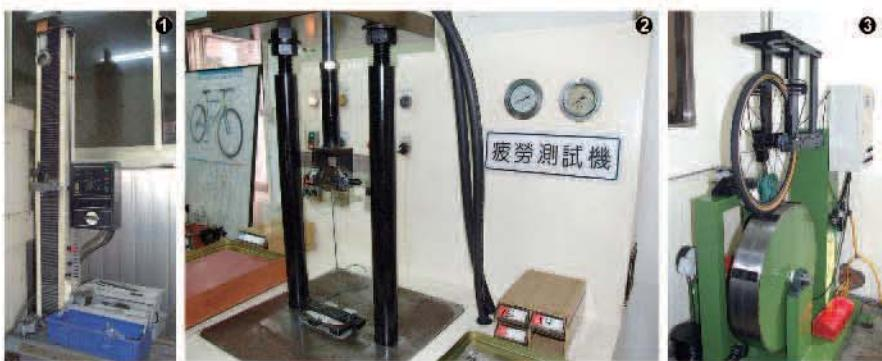
①透過不同的拉力與速度，測試幅條的拉力承受度。
