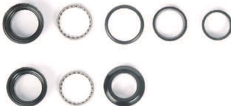
▲上蓋由標準的5P（上圖）研發成為3P（下圖），將迫緊裝置、上塞與防水蓋做一體成型的結合。
