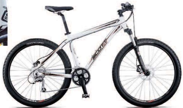
▲Aspect 20內凹車管的特殊設計，行進時可大幅降低風阻。
