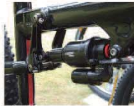
▲▶Scott專利Nude TC後避震，握把部設有遙控把手，可依路況靈活切換全開110mm、半開70mm及鎖死模式。
