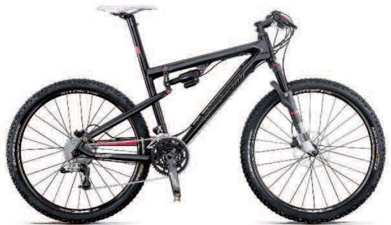
▲▶Scott專利Nude TC後避震，握把部設有遙控把手，可依路況靈活切換全開110mm、半開70mm及鎖死模式。
