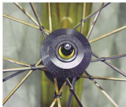
▲Lightweight輪組以碳纖維網網架輪條交叉處，以強化剛性。
