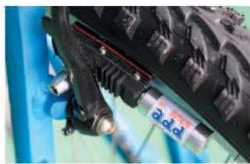
► 長時間使用之後，只須更換磨耗的煞車皮即可恢復如新，一般V夾夾器都能相容適用。
