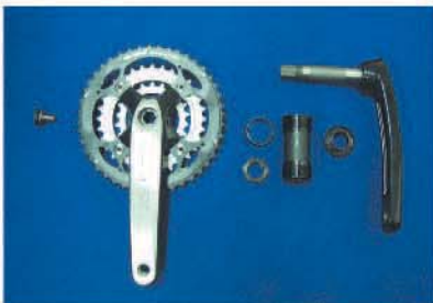
▲09年即將推出的BB與齒盤組將BB裝在左腿部，搭配零件組裝十分簡單。
