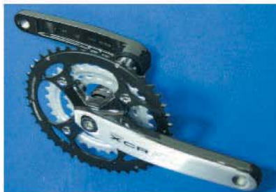
▲09年即將推出的BB與齒盤組將BB裝在左腿部，搭配零件組裝十分簡單。
