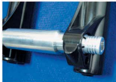
▲快拆穿透裝置軸藉由活動式太陽片固定於前叉端，裝卸車輪更輕鬆。
