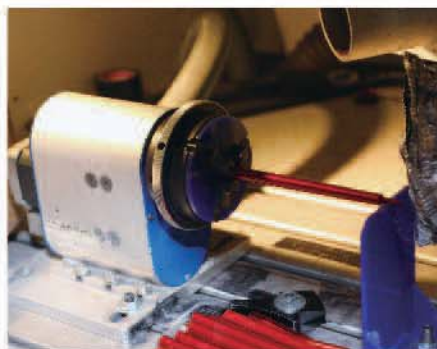
◀可360度旋轉的雷雕儀器，各個層面都能雕出花樣。
