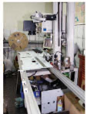
▲此台雷雕儀器可供3公尺的原物料使用。
